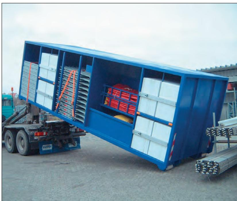
Es gibt zwei Varianten, mit Dach (Leergewicht ca. 2700 kg) und ohne Dach (Leergewicht ca. 2100 kg).
