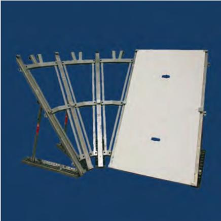
Stützgerüst einer Innenecke aus zwei Elementen. Rechts und links schließen Regelfelder an. Der mittlere Bock trägt nur die beiden Eck-Aussteifungsrahmen. Der Knickwinkel im Grundriss beträgt hier  $3 \times 30^\circ = 90^\circ$ .
